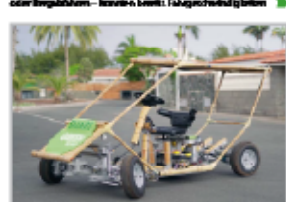
Der dritte Prototyp des Bamboo Solar Car hat eine gute Leistung. Er ist ein kleines, offenes Auto, das aus Bambus gebaut ist. Es hat ein Solardach, das die Batterie speist. Das Fahrzeug ist für die Nutzung in ärmeren Ländern gedacht, wo es als Transportmittel für kleine Warenmengen dienen kann. (Bild: ITQ)
